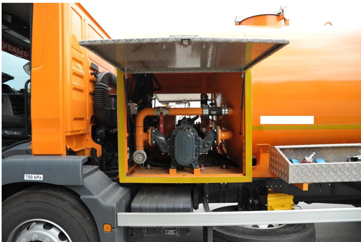
Fotografia 5: Ľavý bočný pohľad na prevádzkovú časť kropičky
