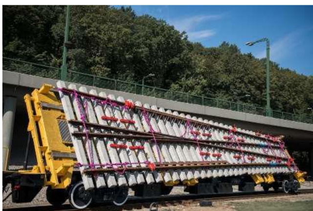
Obrázok č. 7 Železničný nákladný vozeň na prepravu koľajových polí spoločnosti Voestalpine
