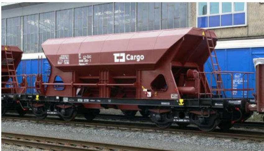
Obrázok č. 10 Výsypný vozeň na dopravu štrku Faces
