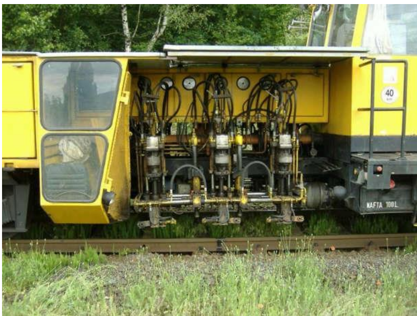
Obrázok č. 11 Dvanásťvretenová zatáčačka DZ 500
