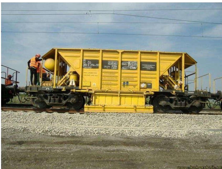
Obrázok č. 9 Vozeň na prepravu štrku Chopendozátor
