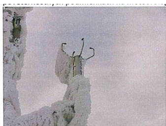
Obr. B: Ponúkaný anemometer Thies so zvislou orientáciou senzorov, meteorologická stanica SHMÚ Chopok
