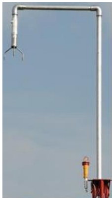
Obrázok 7 Ultrasonický anemometer inštalovaný zvislo smerom dole [zdroj: https://library.wmo.int/pmb_ged/iom_116_en/Session%203/P3_21_Schubotz_Intercomp_birdrepellingtechniques_ultrasonic_anemometers.pdf ].
