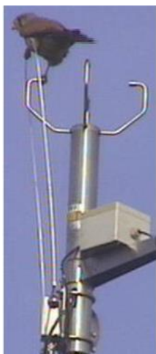
Obrázok 5 Vtáčí jedinec na ultrasonickom anemometre so pseudovertikálnym riešením [zdroj: https://library.wmo.int/pmb_ged/iom_116_en/Session%203/P3_21_Schubotz_Intercomp_birdrepellingtechniques_ultrasonic_anemometers.pdf ]
