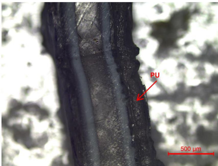
Obr. 2: Mikroskopický snímok hrany plastovej karty s označením polyuretánovej vrstvy (PU)
