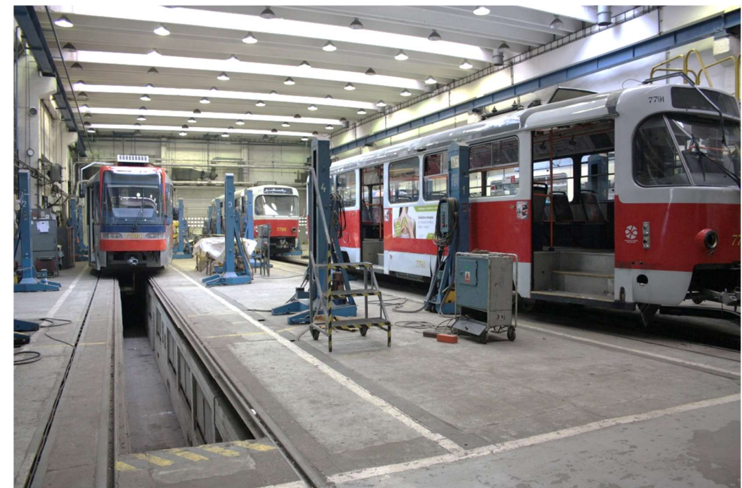
Interiér objektu ústredných dielní električiek – prehliadkové jamy
